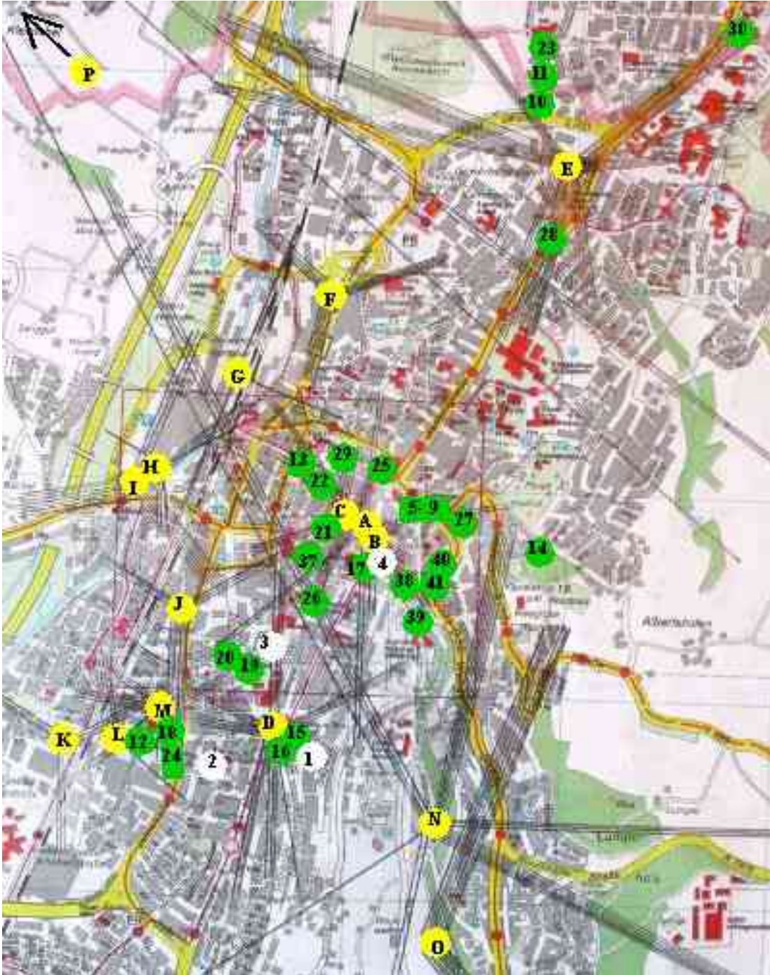
Ausschnitt aus Stadtplan Ravensburg, Städte-Verlag, E. v. Wagner & J. Mitterhuber. Hinzugefügt: Standorte von Mobilfunksendeanlagen (gelb) mit Hauptstrahlrichtungen der Sektorantennen (Abruf auf EMF-Datenbank im Sept. 2020). Standorte von Bäumen mit Sichtverbindung (grün), ohne Sichtverbindung oder unter Hauptstrahlen (weiß),
